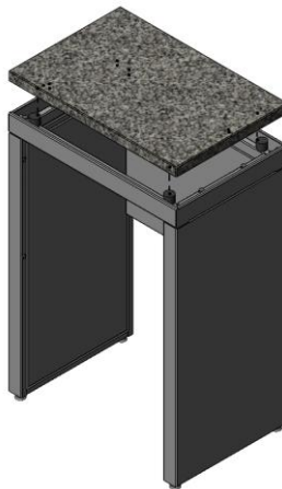
Рис. 3. Установка рабочей поверхности
